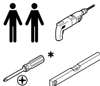
\* **VORSICHT:** Bei Verwendung eines Akkuschraubers (nicht empfohlen) möglichst niedrige Drehmomentstufe wählen!
